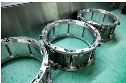
1382 In diesen Schneidetrommeln werden die Kartoffeln in hauchdünne Scheiben geschnitten.
