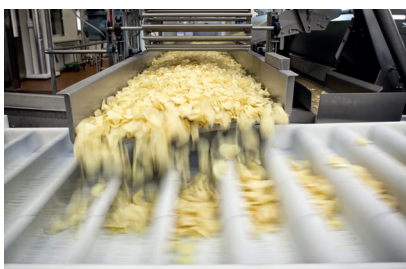
1540 Bevor die Chips gewürzt werden können, werden sie getrocknet, gelockert und portioniert.
